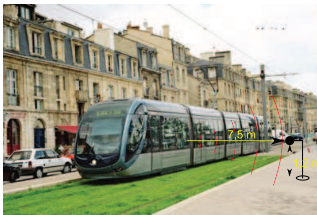
FIGURE 1.2 – Réglementation sur les points de mesure du bruit émis par un train.
