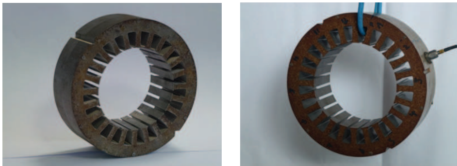
FIGURE 4.5 – Cas test : stator avec sa denture en condition libre-libre au-delà de 200 Hz.
