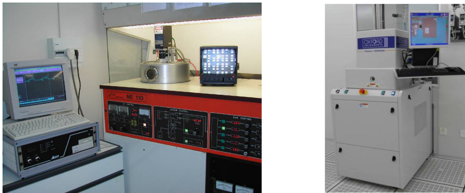
FIGURE 3.5 – Bâtis de gravure plasma utilisés sur la plateforme Nanolyon dans les études précédentes au laboratoire : RIE Nextral NEE110 (à gauche), Oxford NGP80 (à droite).
