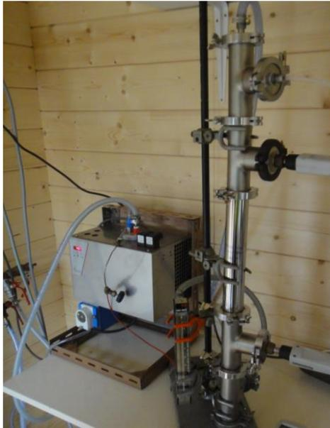
Figure 67. Sécheur par refroidissement « Peltier » du biogaz en entrée du réacteur.
