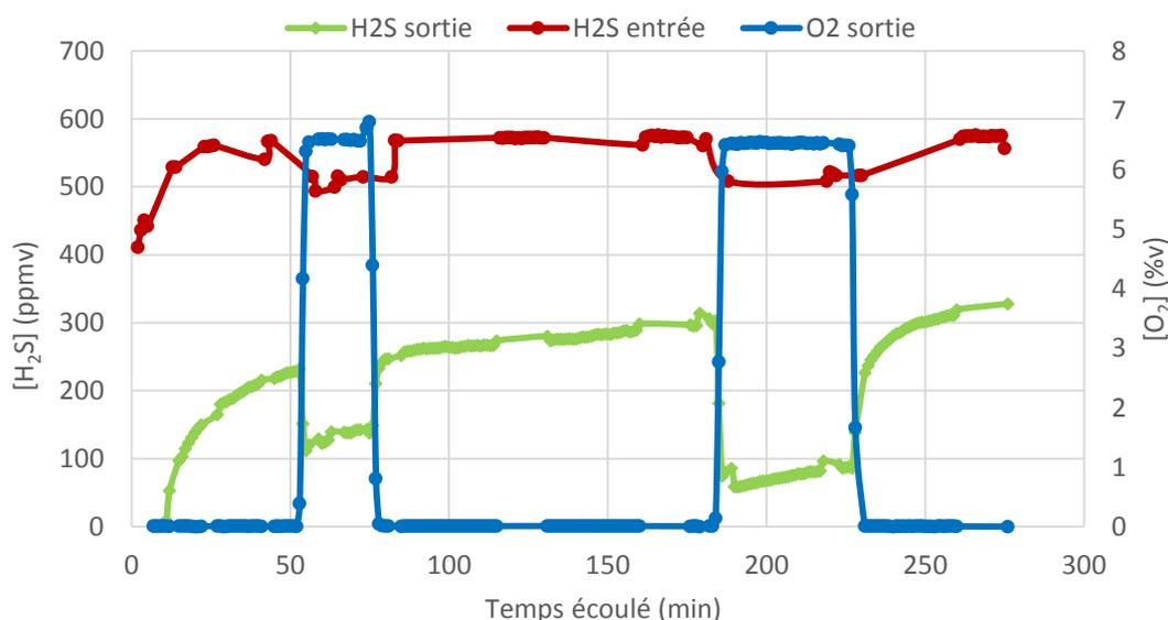
Figure 76. Suivi des teneurs en H<sub>2</sub>S (entrée/sortie) et O<sub>2</sub> en fonction du temps.
