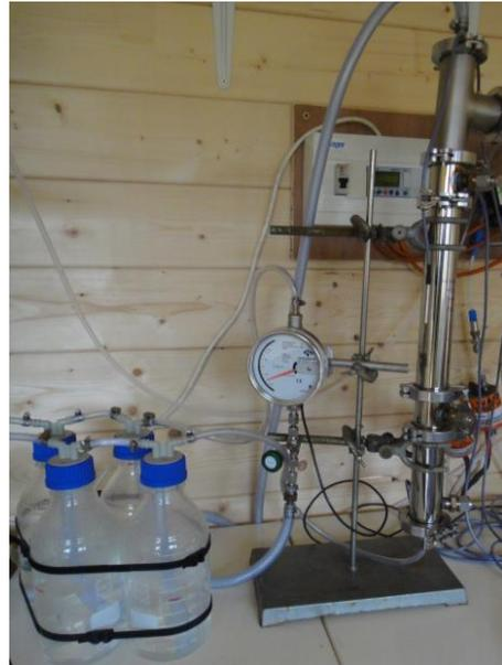
Figure 68. Système d'humidification du biogaz par absorption d'eau (ici sans bain thermostaté).
