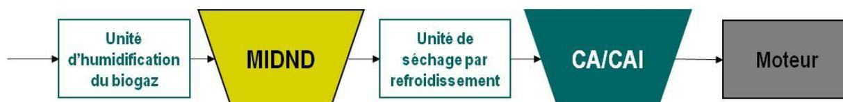
Figure 110. Proposition d'une chaîne « alternative » de traitement de biogaz d'ISDND, avec une 1<sup>ère</sup> étape d'abattement d'H<sub>2</sub>S avec des MIDND.
