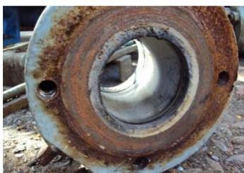
Figure 20. Exemple de corrosion provoquée par H<sub>2</sub>S.
