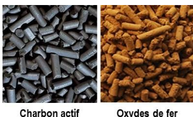
Figure 23. Aspect des adsorbants commerciaux les plus utilisés pour l'élimination d' H_2S des biogaz.
