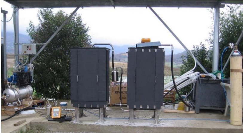
Figure 25. Pilote BABIU à l'ISDND de Podere Rota en Italie [Mostbauer et al., 2012].
