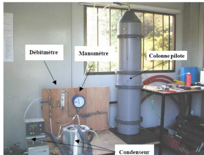
Figure 24. Installation du pilote de désulfuration du biogaz avec des MIDND [Radu-Tirnovanu, 2004].
