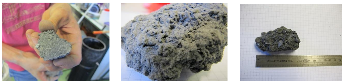
Figure 85. Prise en masse des MIDND. Agglomérats de mâchefers usagés.
