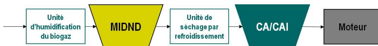
Figure 110. Proposition d'une chaîne « alternative » de traitement de biogaz d'ISDND, avec une 1 ère étape d'abattement d'H 2 S avec des MIDND.
