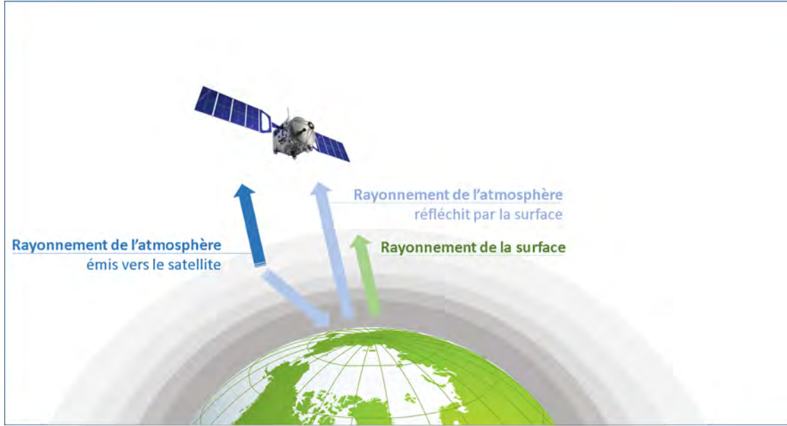
FIGURE 1.7 – Sources de rayonnements contribuant à la mesure de température de brillance par le radiomètre au sommet de l’atmosphère
