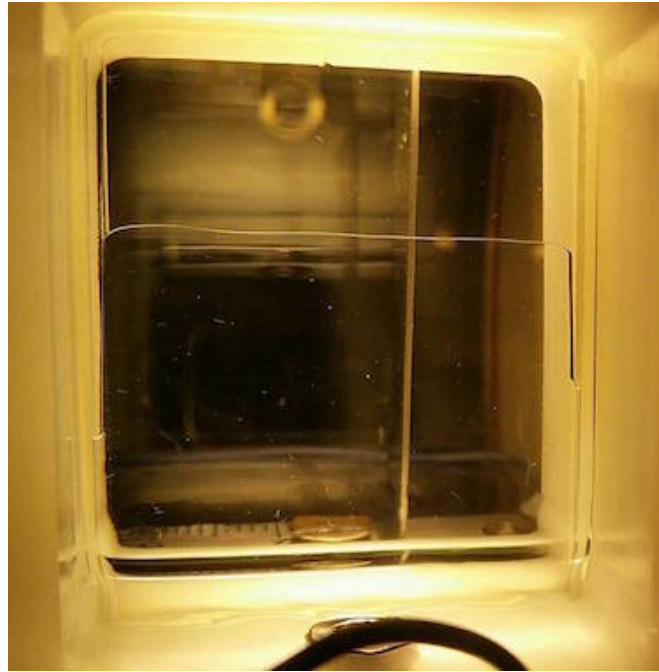
Figure 3.2 – L’horizontalité de l’interface est utilisée pour contrôler le parallélisme des électrodes. La caméra est réglée pour faire la mise au point sur l’interface au niveau du réglét, à cet endroit les effets de bords sont négligeables.
