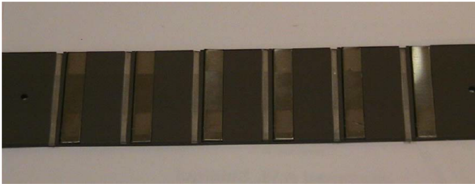
Figure 1.9 – Configuration d'électrodes utilisée pour le pompage de film liquide [SID2009].
