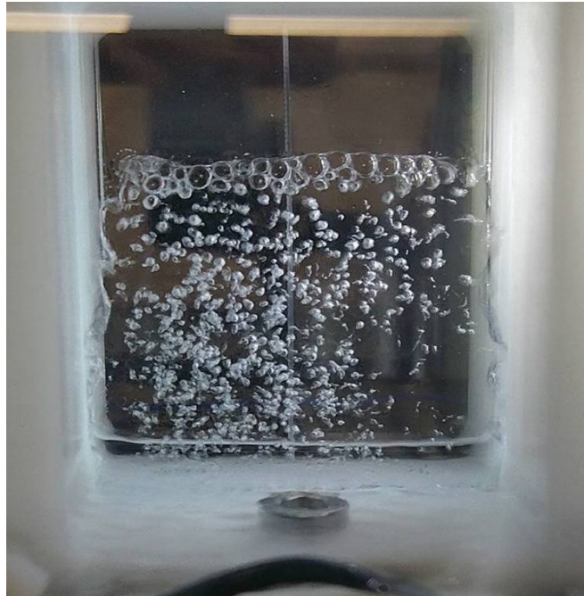
Figure 3.6 – La présence de bulles liées à l'effet Joule entre les électrodes perturbe la mesure de la position de l'interface.
