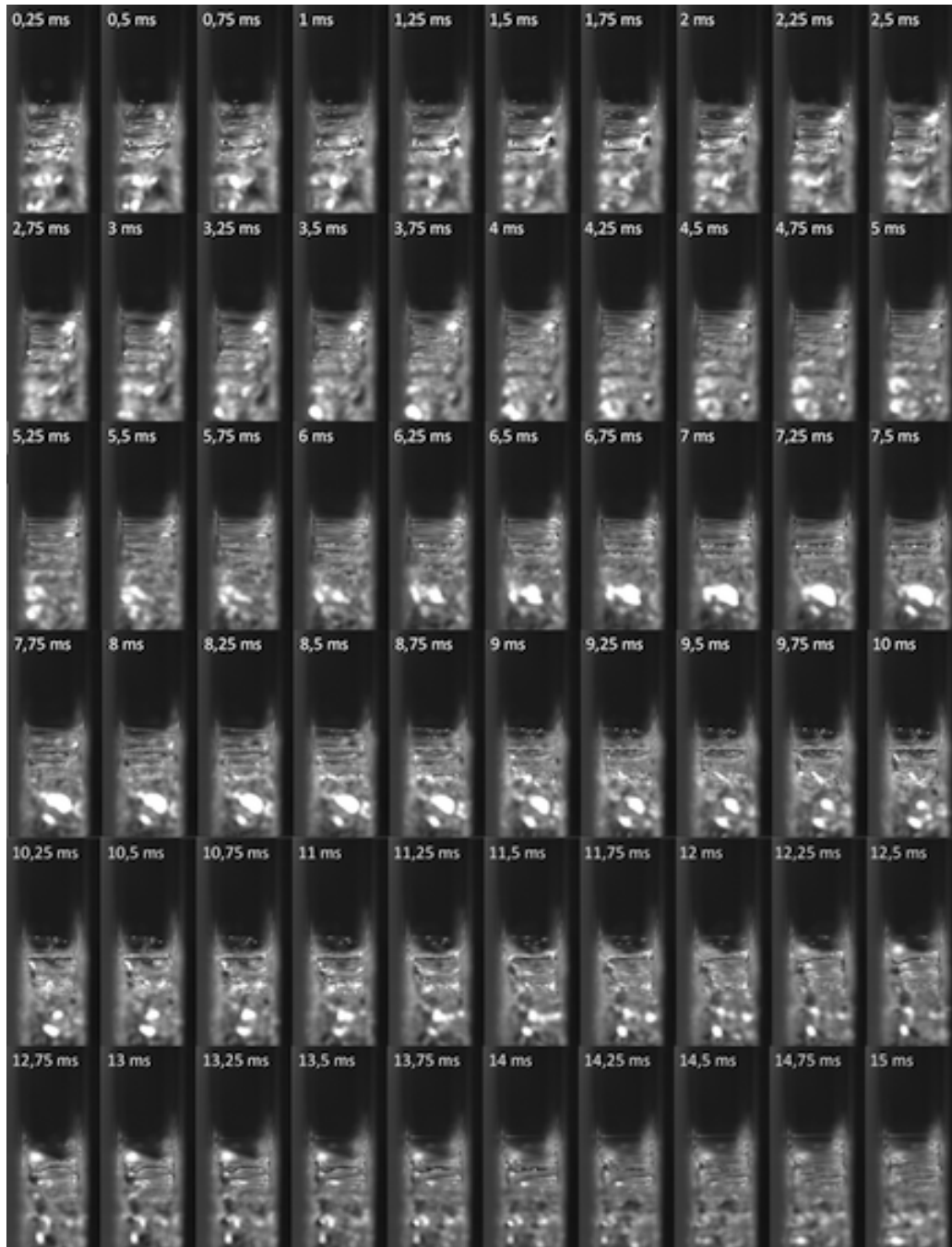
Figure 3.32 – Évolution temporelle de la structure de l'interface du HFE-7000 à 50 Hz et pour un champ efficace de 2,35 kV/mm, la distance inter électrodes est de 3 mm.
