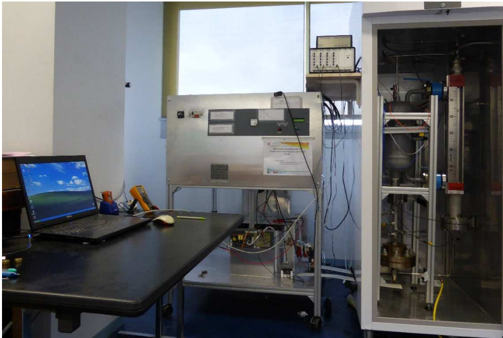
Figure 2.28 : Photo du banc d'essais avec la chambre froide à droite, le PC relié au système d'acquisition en haut sur l'étagère et le banc électrique au centre en arrière-plan.
