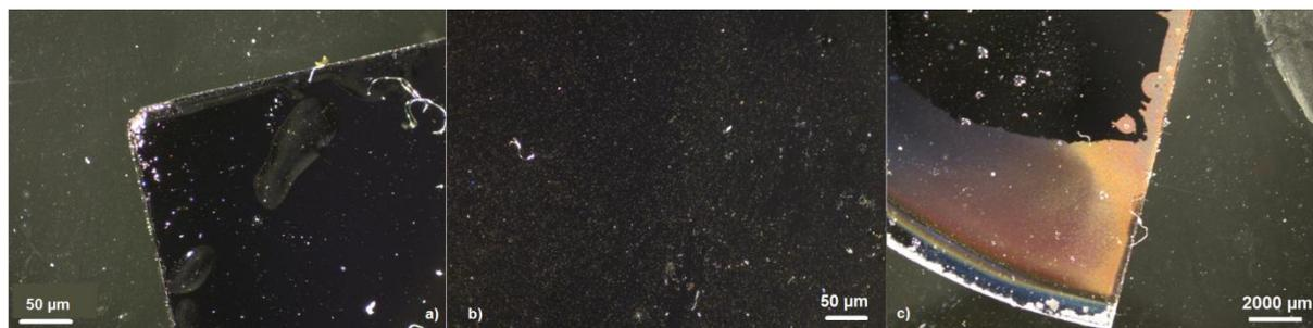
Figure 83 : Images prise au microscope optique d'échantillons de Si-Se4-PIB avant immersion (a), après 10 semaines d'immersion dans l'eau distillée (b) et après 10 semaines immergé dans de l'eau de mer (c)
