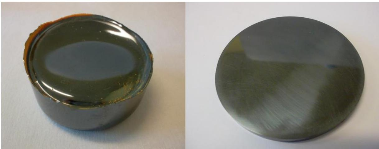
Figure 27 : Photos d'un verre massif après recuit (à gauche) et la cible obtenue après découpe et polissage (à droite)
