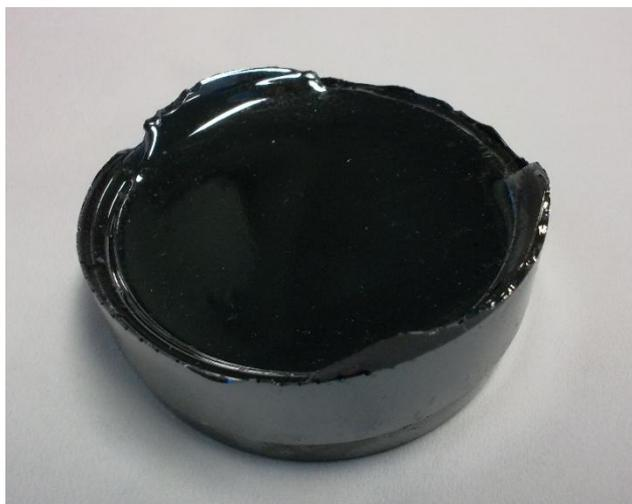
Figure 23 : Photo d'un verre de chalcogénures du système Ge-Sb-Se
