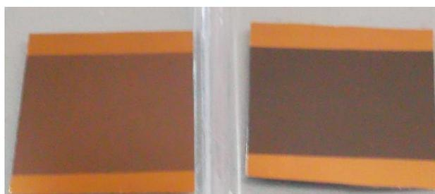
Figure 135 : Photo du premier échantillon à avoir été recouvert d'or ( $P_{\text{RF}} = 50 \text{ W}$ ,  $t = 60 \text{ s}$ ) (à gauche) et d'un échantillon sans film d'or (à droite)
