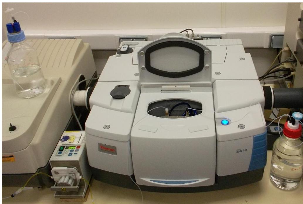
Figure 86 : Photo du montage comprenant, de droite à gauche, une bouteille en verre enfermant la solution à analyser, une cellule ATR contenant le prisme de ZnSe placé dans un spectromètre FTIR, une pompe péristaltique et enfin une bouteille en verre pour la récupération de la solution après analyse.
