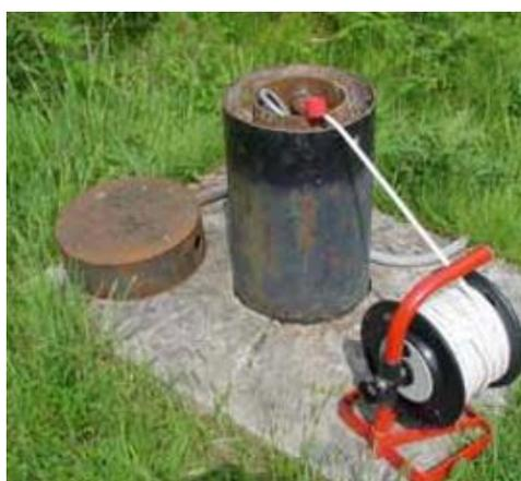
Figure 117 : Photo d'un piézomètre [36]
