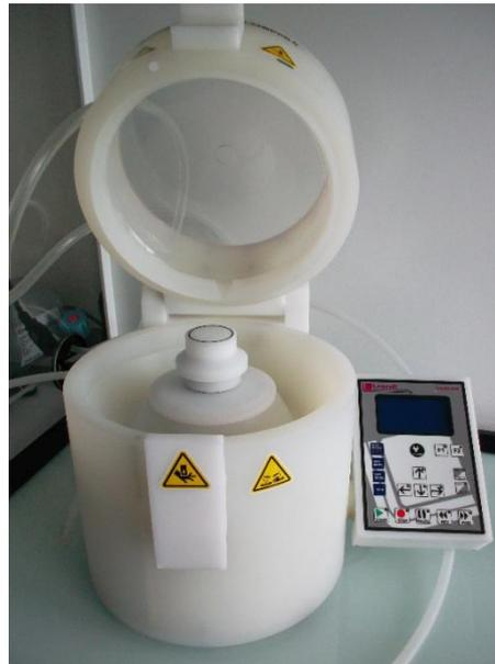
Figure 68 : Photographie du dispositif de spin-coating utilisé pour le dépôt de polymère
