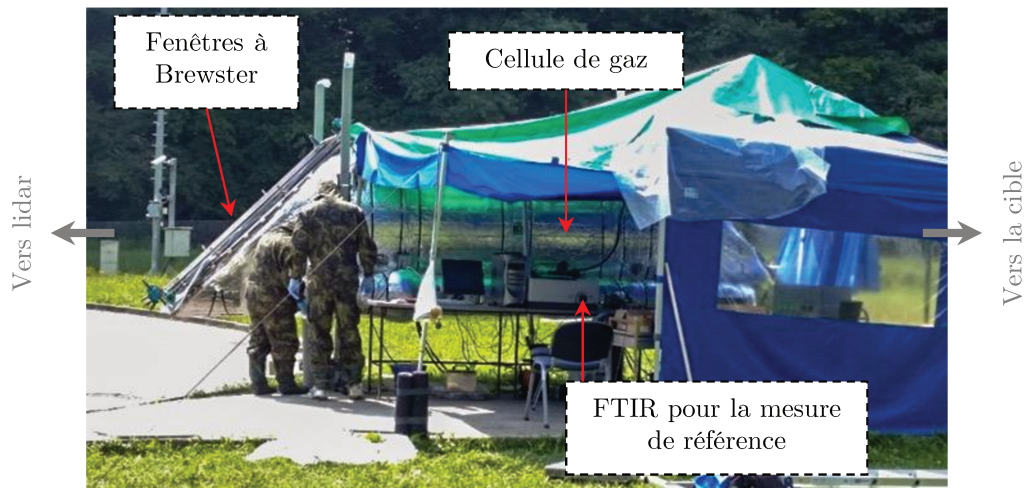
FIGURE 4.19 – Image de la cellule de gaz lors de la dissémination de gaz de combat. La cellule est chauffée à 60^{\circ}\text{C} et ventilée afin d'homogénéiser la concentration de gaz.
