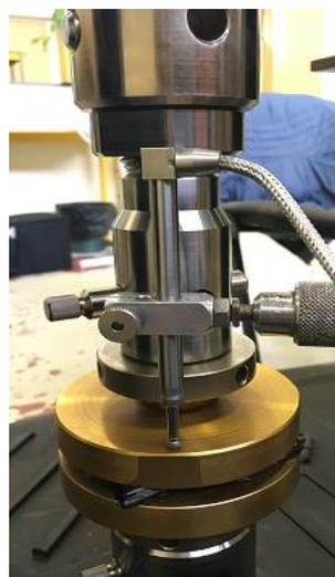
Figure 2.20 Dispositif d'essai de compression transverse
