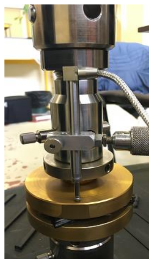
Figure 2.20 Dispositif d'essai de compression transverse
