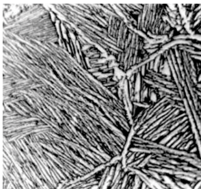
Figure 14 : Dans l'alliage TA6V, la phase \alpha est très majoritaire (en gris). La phase \beta (en noir) entoure les grains de la phase \alpha . Exemples de morphologies de grains rencontrées dans l'alliage TA6V biphasé \alpha + \beta : a) structure lamellaire, b) structure équiaxe et c) structure duplex [92].
