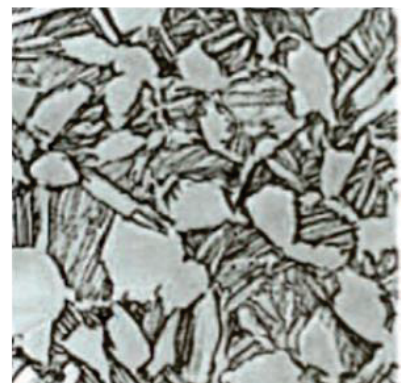
Figure 14 : Dans l'alliage TA6V, la phase \alpha est très majoritaire (en gris). La phase \beta (en noir) entoure les grains de la phase \alpha . Exemples de morphologies de grains rencontrées dans l'alliage TA6V biphasé \alpha + \beta : a) structure lamellaire, b) structure équiaxe et c) structure duplex [92].
