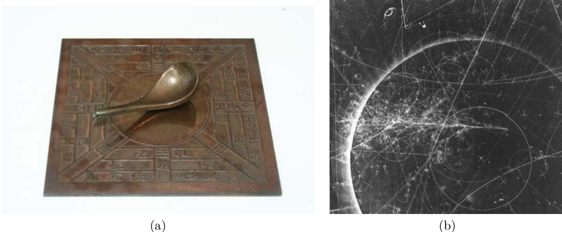
FIGURE 2.1 – (a) Cuillère indiquant le sud du temps des Han (206 avant J.-C. - 220 après J.-C.) (b) Des électrons en trajectoire rectiligne sont propulsés dans une chambre à bulles soumise à un champ magnétique. Il s’agit d’un liquide à la limite de l’ébullition dans lequel l’électron, sur son trajet, forme un noyau d’ébullition et produit en cédant localement de l’énergie, un chapelet de bulles, ce qui permet de visualiser sa trajectoire. On remarque alors que les trajectoires sont courbées, ce qui est caractéristiques de la présence d’un champ magnétique.
