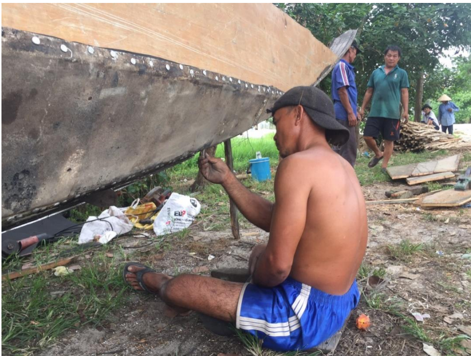
Photo 11 : un ouvrier enfonce des clous
