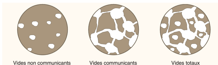
Figure A.1- Définition des porosités ouverte et totale (Abdo, 2007)
