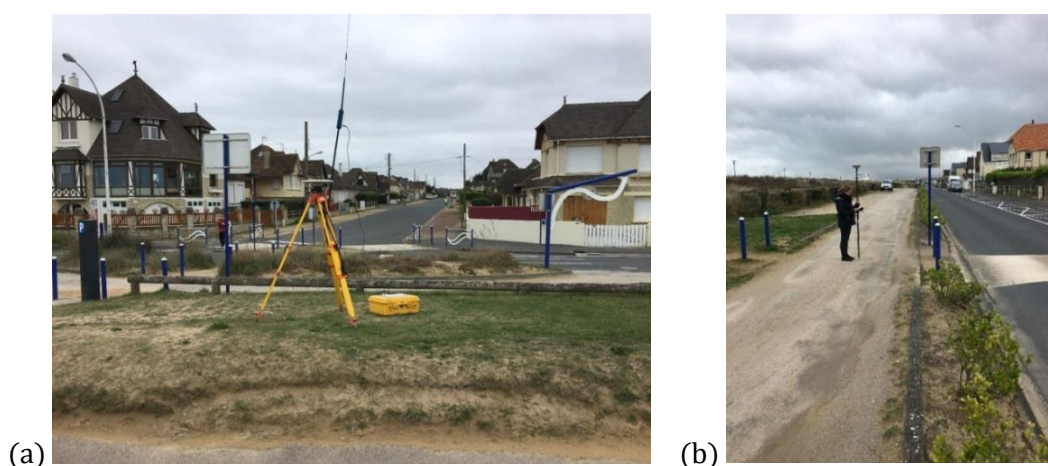
Figure 2.31 – Photos des conditions du levé de terrain. (a) Base DGPS placée sur la dune et (b) récepteur mobile placé sur un parking le long du boulevard Aristide Briand (Cardinal et al., 2017)
