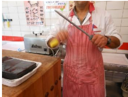
Fig. 60: Affûtage à l'aide d'un fusil (© N. Thomas).
