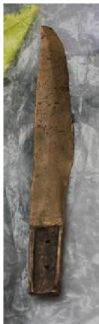
Fig. 85: Test 3 (pierre à aiguiser, à affûter naturelle crétoise grand format face B contre la lame en bronze alliage 10% d'étain). Zoom sur les traces laissées sur la lame en bronze (© N. Thomas; C. Roos).
