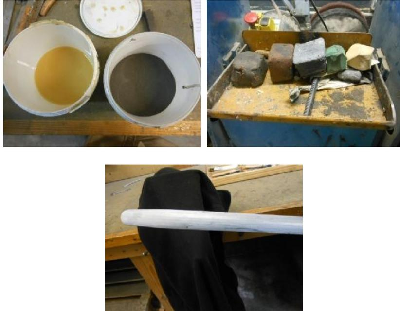
**Fig. 70: Poudres, gommés et fusils utilisés de nos jours par les couteliers auvergnats de Thiers lors de l'entretien des lames de couteaux (actions d'abrasion: aiguisage, affûtage et polissage)<sup>94</sup>**
