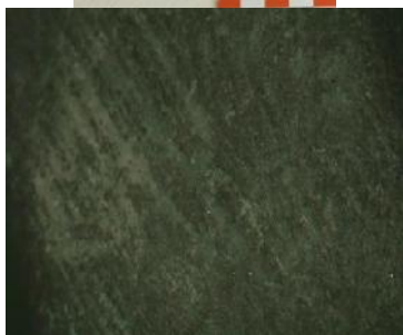
Bord 1 X30 : Stries prononcées, parallèles, longilignes et concentrées
