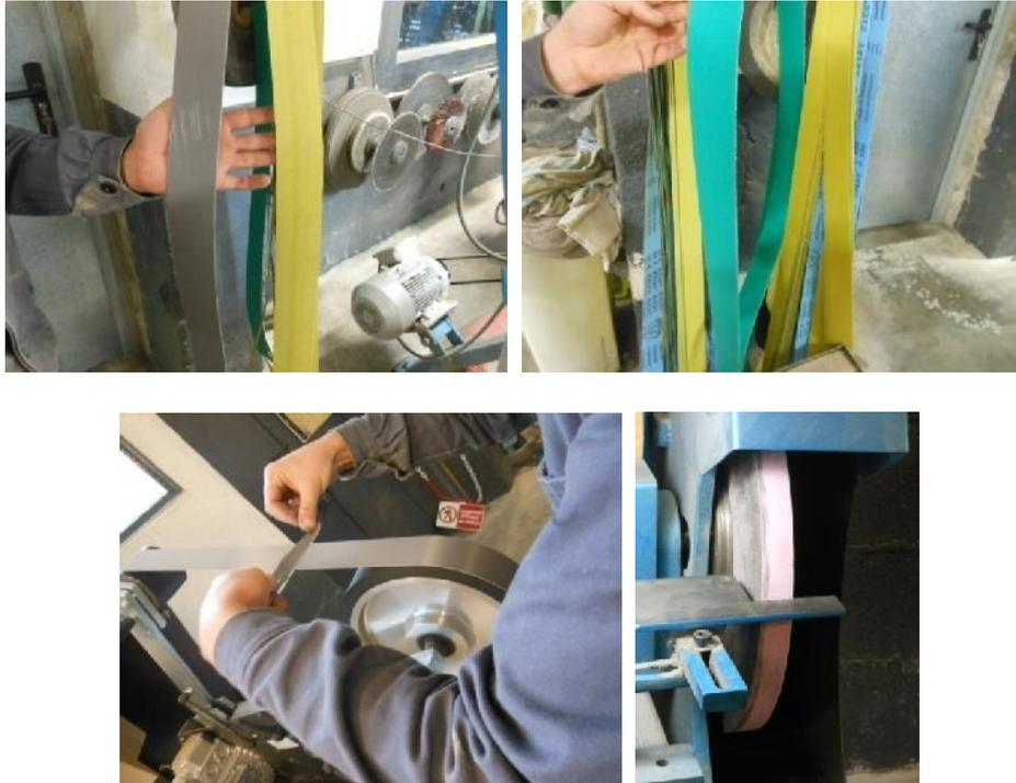
**Fig. 69: Bandes abrasives de différentes granulométries, utilisées de nos jours par les couteliers auvergnats de Thiers lors des actions d'aiguisage et de polissage des lames de couteaux<sup>93</sup>**
