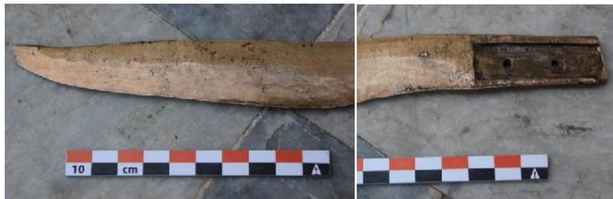
**Fig. 84: Test 3, pierre à aiguiser, à affûter naturelle crétoise grand format face B contre la lame en bronze alliage 10% d'étain (© C. Roos).**
