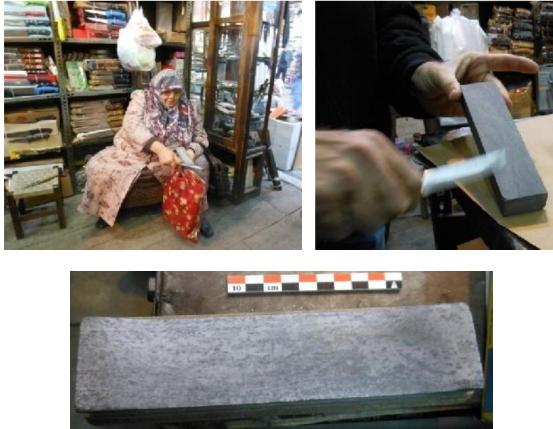
Fig. 66: Affûtage d'un couteau par une femme turque ; démonstration d'affûtage par un coutelier spécialisé de la ville de Bursa (artisan de la coutellerie Karaefe ) et photographie de l'outil en pierre employé à cet effet (© N. Thomas).
