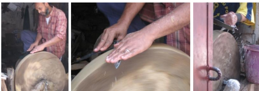
Fig. 40: Affûtage d'une lame de tranchant de couteau à l'aide d'une meule rotative active à Fès (Maroc) en Juillet 2012 (© H. Procopiou).
