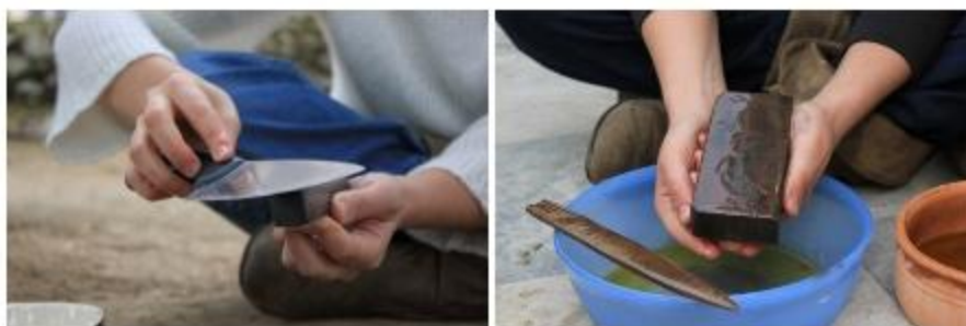
Fig. 71: Expérimentation – Affûtage d'une lame en inox moderne (image de gauche) et d'une lame en bronze – alliage d'étain 7% (image de droite) à l'aide de deux pierres à aiguiser (pierre des Pyrénées à gauche et pierre crétoise d'Elounda à droite) (© Clélia Roos).
