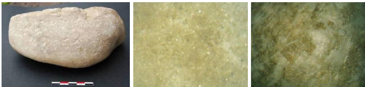
Fig. 92: Échantillon en grès quartzitique à T0 (images de gauche et centrale) et état de surface à T3 (X10) (vignette de droite) (©N. Thomas).
