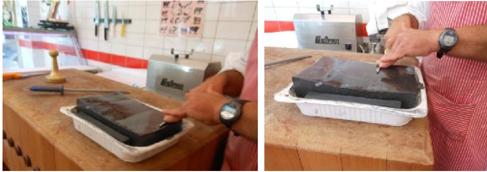
Fig. 59: Affûtage d'un couteau de boucher – Utilisation de l'outil en pierre avec de l'huile d'olive. Probable pierre crétoise d'Elounda (© N. Thomas).
