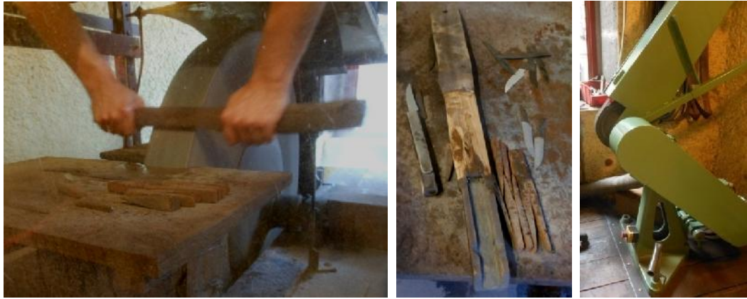
Fig. 67: Affûtage de couteau à la meuleuse (feutres et abrasifs industriels), démonstration au sein du musée de la coutellerie de Thiers (meule à eau, image de gauche) (© N. Thomas).
