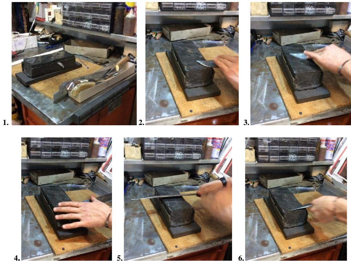
**Fig. 65: Actions d'affûtage d'un couteau (lame de grand format) par un coutelier crétois spécialisé - Coutellerie *Skalidakis* (Chania, Crète occidentale - Grèce) avec la pierre crétoise d'Elounda (employée avec de l'huile d'olive)<sup>92</sup> (© N. Thomas).**
