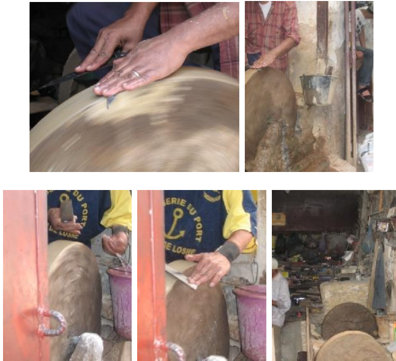
Fig. 62: Aiguisage et affûtage de lames de couteaux à Fès (Maroc) (© H. Procopiou).
