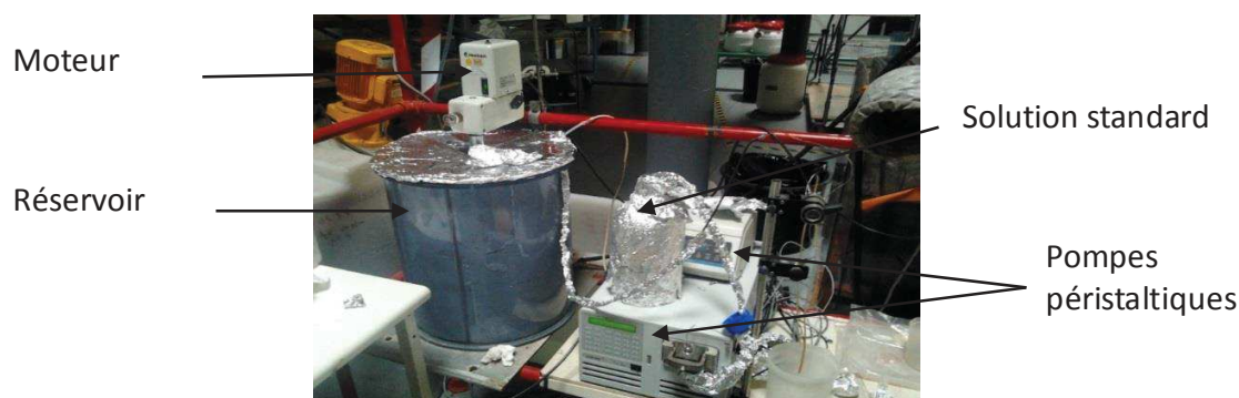
Figure 38 : Pilote de calibration des Chemcatcher
