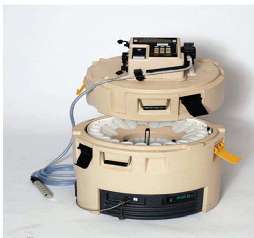
Figure 8 : Préleveur automatique (SIGMA 900) utilisé
