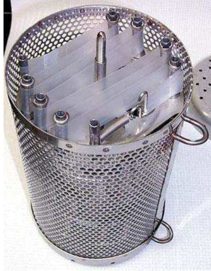
Figure 32 : Echantillonneur passif « SPMD » avant installation dans le milieu aquatique
