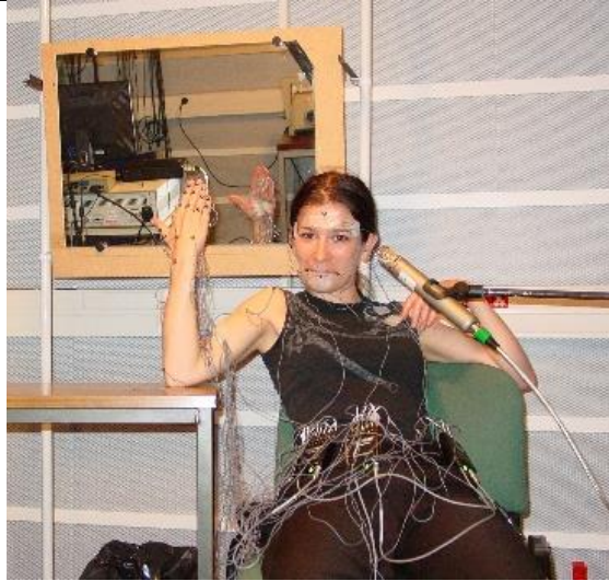
Figure I-8 : Dans la chambre anéchoïque de la plateforme BEDEI de GIPSA-lab, sujet équipé des diodes à émission Infra rouges du système optotrak.
