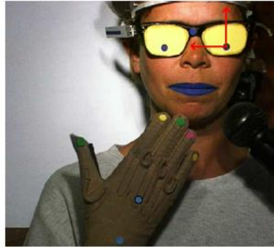
Figure I-4 : Image d'une séquence extraite de l'enregistrement vidéo d'une codeuse portant un gant de données pour capturer la flexion des segments de doigts sur lequel des pastilles de couleur sont utilisées afin de faciliter l'extraction de leurs coordonnées par traitement d'images (utilisation d'artifice de maquillage des lèvres pour les mêmes raisons). Les axes en rouge définissent le repère des coordonnées. Figure issue de Attina et al., 2004.
