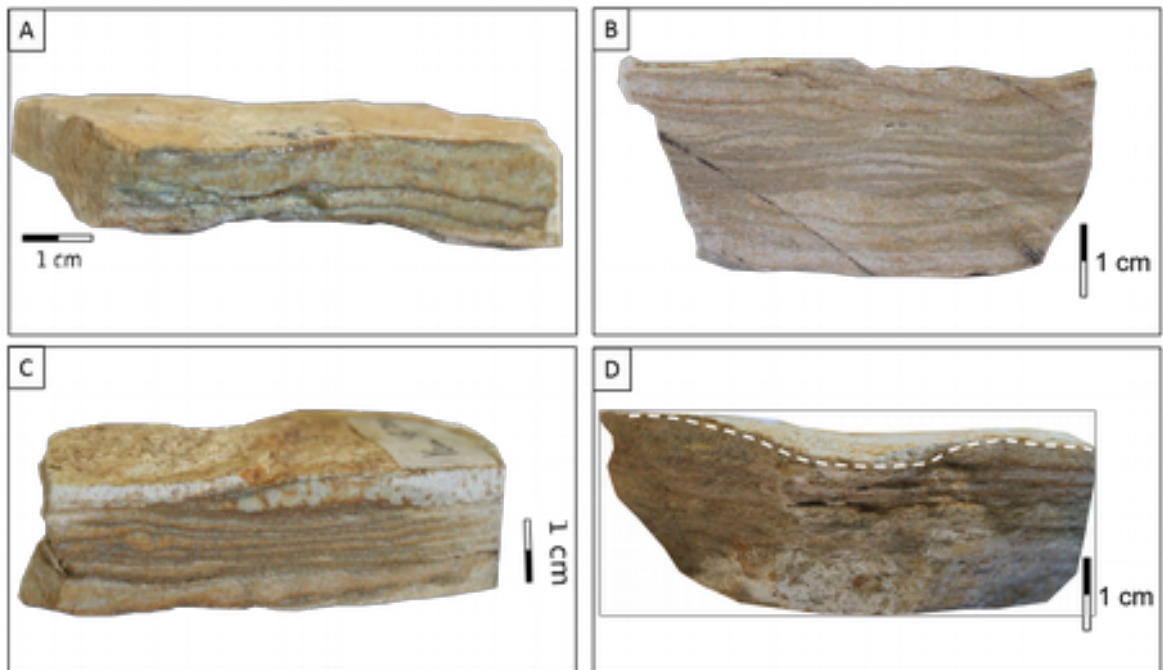
Figure 4.5 - Photographies des faciès grés-silteux à silto-argileux (SA) de la base de la séquence Yampilsky : A) grès silteux à grain fin et débit en plaquettes, constitués de lits demi-centimétriques de matériaux gris et de matériau ocre. A la base, certains lits gris sont riches en grains sombres (minéraux lourds), B) dépôt silto-gréseux à gréseux présentant un litage fruste et un débit feuilleté grossier. Sur cassure, les plaques débitées montrent une surface onduleuse (figures de courants ?), C)/D alternances gréseuses à grés-silteuses où les grès fin gris clair sont disposés en lentilles pouvant se chevaucher partiellement (anciennes rides ?).
