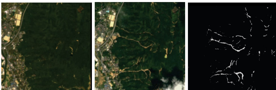
(a) Image AVNIR-2 acquise en 14 Juin 2009 (avant la catastrophe) (b) Image AVNIR-2 acquise en 30 Juillet 2009 (après la catastrophe) (c) Résultats de détection de glissements de terrain
