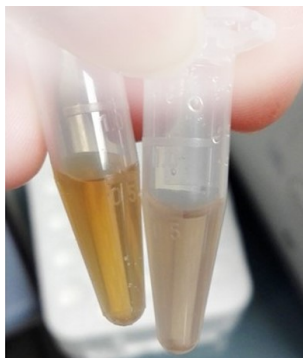
FIGURE 7.12 – Photographie d'un échantillon à gauche à 0,25 : 1 (S : Ag) et à droite à 0,05 : 1 (S : Ag)
