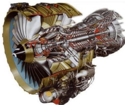
Figure 1: Coupe d'un CFM56-7B, moteur du Boeing 737.
