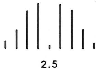
Spectres des fonctions de Bessel J_n(\theta)
