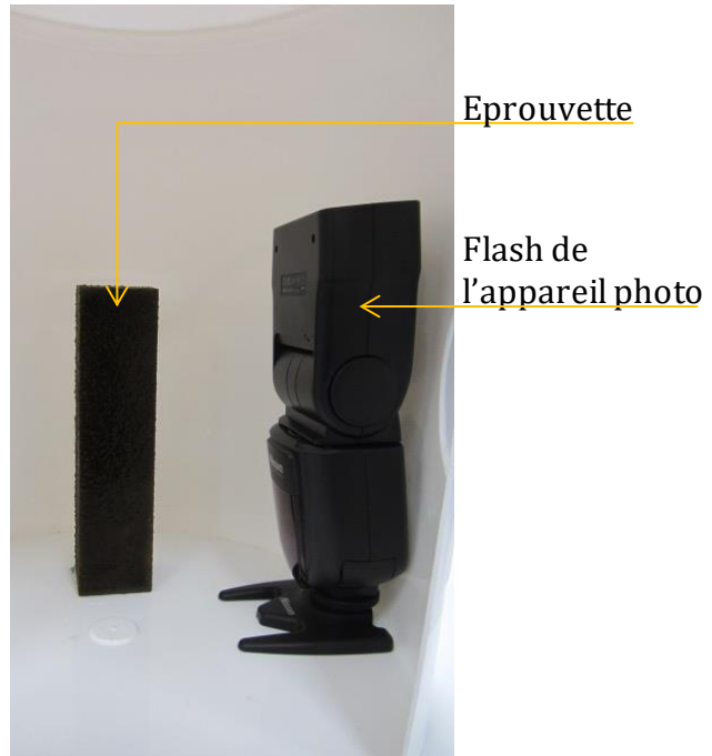
Figure 2-27 : Montage à l'intérieur du caisson photographique
