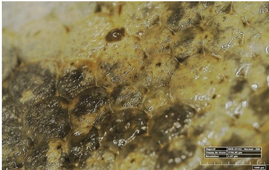
Figure 1-17 : Détail de la matrice extracellulaire, visible sous à l'œil nu et sur microscope numérique à faible grossissement (x80) (photographie effectuée au sein du laboratoire de l'ESITC Caen)
