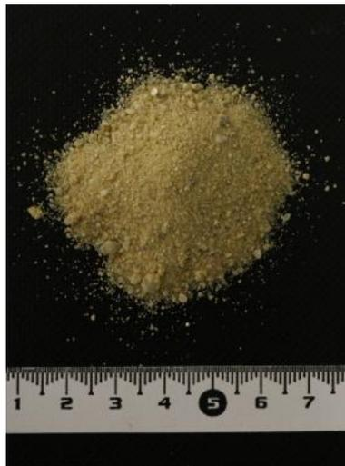
Figure 2-1 : Sable siliceux 0/2 mm
