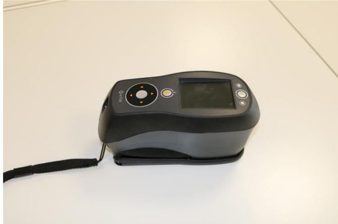
Figure 2-17 : Spectrocolorimètre Ci60 (X-Rite) utilisé
