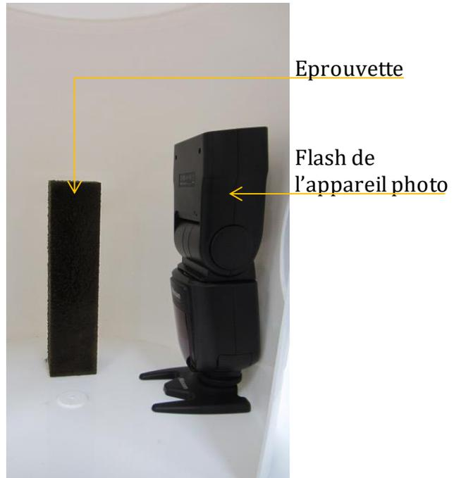
Figure 2-27 : Montage à l'intérieur du caisson photographique
