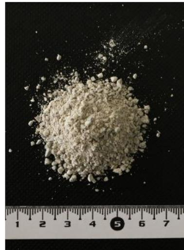
Figure 2-2 : Sable calcaire 0/4 mm
