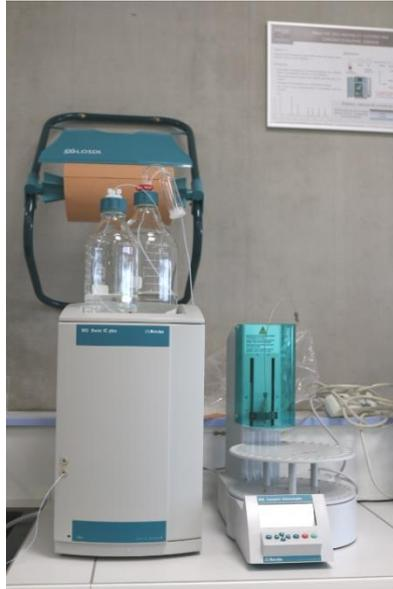
Figure 2-7 : (gauche) Chromatographie ionique, (droite) passeur
