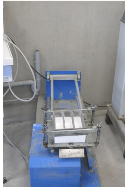
Figure 2-6 : Table à chocs utilisée pour la confection des éprouvettes de mortier
