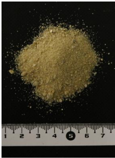
Figure 2-1 : Sable siliceux 0/2 mm
