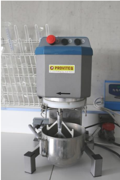
Figure 2-5 : Malaxeur utilisé pour la confection des éprouvettes de mortier
