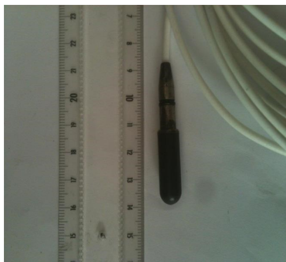
Figure IV.4. Aperçu de l'hydrophone B & K 8103 utilisé comme source acoustique [Mori13]
