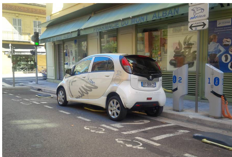
FIGURE 2.2 – Voiture électrique garée dans une station entrain de se recharger, source image https://www.auto-bleue.org/fr
