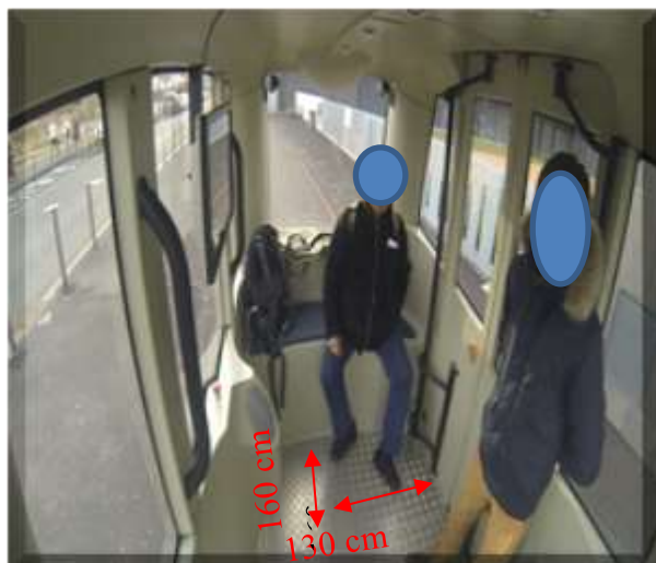
Figure E : Surface au sol à l'intérieur des NAV1
