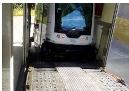
Figure 53 : Collision d'une NA en phase de chargement. Un Lidar a été endommagé.
