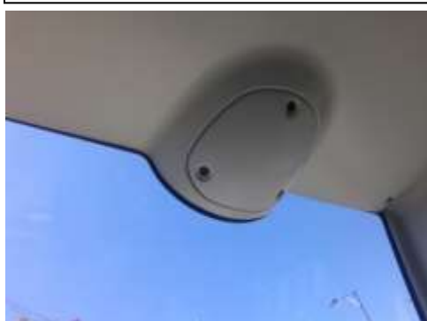
Figure 54 : Boîtier abritant la caméra avant. Pour sortir les caméras du boîtier (opération « fréquente » d'après un exploitant), il faut « démonter quasiment tout l'habitacle ».
