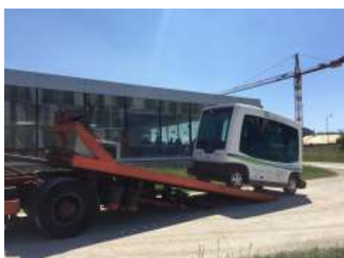
Figure 52 : NA en panne de batterie. Ne disposant pas de système de roue libre, l'exploitant a dû faire intervenir un dépanneur.
