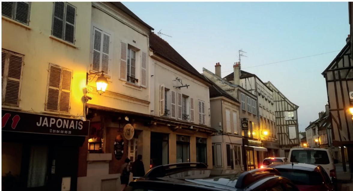
Fig.127. Nombre des maisons médiévales de Provins ont de nos jours une façade en plâtre, des ouvertures régulières et les ornements de l'architecture classique : bandeaux, corniche, encadrements moulurés, qui ont été rapportés ultérieurement. Source : Tiffanie Le Dantec.
