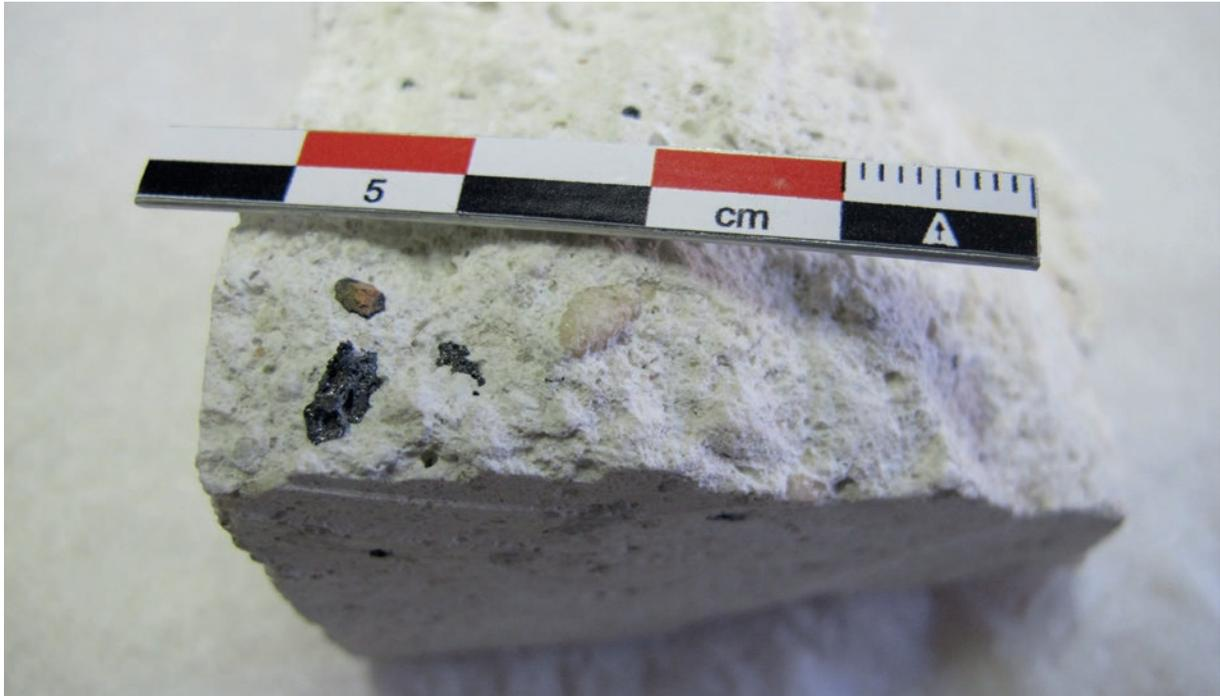
Fig.39. Fragment d'enduit de plâtre prélevé sur le Théâtre de la Renaissance (Paris). Dans la matrice on observe du coke (grain noir brillant et poreux) et du gypse incuit (grain beige cristallisé). Source : Jean Ducasse-Lapeyrusse, LRMH, 2015.
