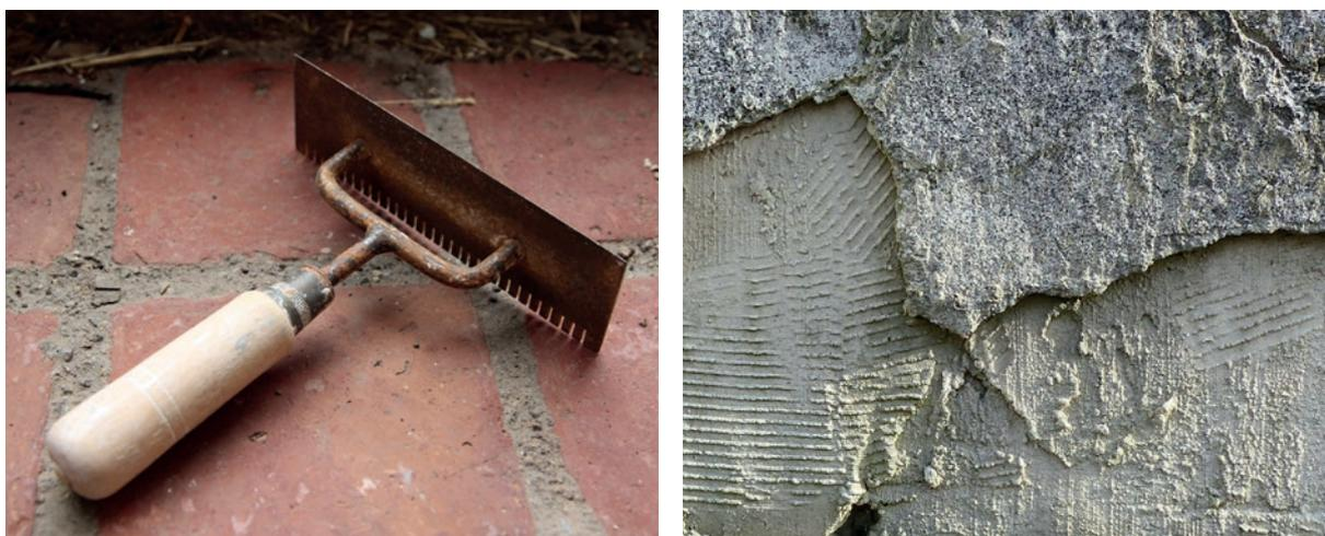
Fig.51. La berthelée (à gauche) possède deux côtés. Le dentelé permet d'imprimer des stries sur les couches de finitions ou de faire une surface rugueuse pour les crépis, bien que cet usage semble récent (à droite). Le côté tranchant permet de dresser et couper la surface de la couche de finition.
