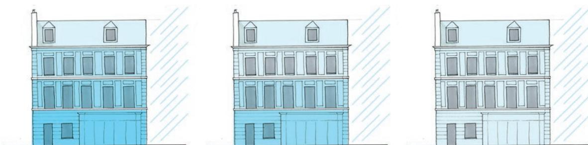
Fig.105. Volume d'eau ruisselant sur les façades en cas d'épisode pluvieux. (Gauche) Absence de corniche et bandeaux. Ou corniche et bandeaux sans larmiers. (Milieu) Corniche avec larmier, ou mise en place d'une gouttière filante. Absence de bandeaux. (Droite) Corniche et bandeaux avec larmiers. Source : Tiffanie Le Dantec.
