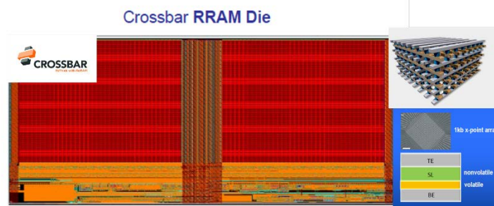
Figure 2-7 Produit OxRRAM commercialisé par la société Crossbar. [20]
