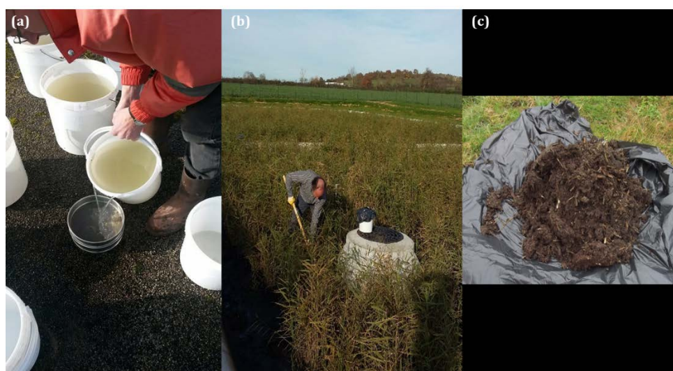
[Figure II.5] Prélèvements (a) des matières en suspension (tamisage) et (b) des boues à la surface du 1 er étage (en haut) ; (c) échantillon de boues obtenu après pelletage avant l'élimination des rhizomes et graviers
