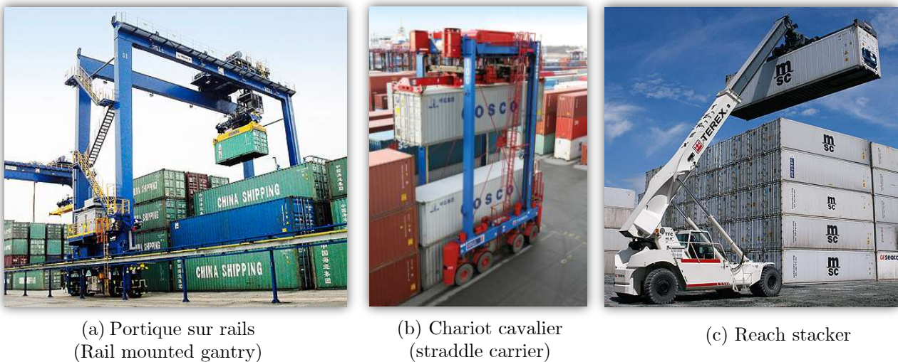
FIGURE 1.2 – Principaux engins portuaires pour la manutention de conteneurs (source : www.terex.com )
