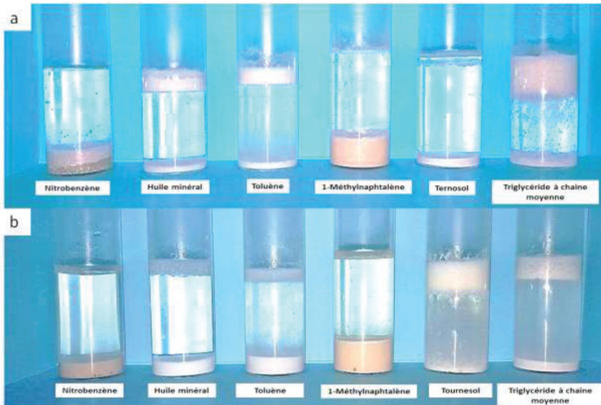
Figure C.II.2. Photographies des émulsions d'une série d'huiles (20%) stabilisées par 1% de TiO 2 (a) et TiO 2 -F(b), respectivement.
