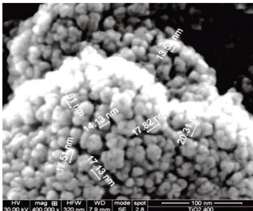
Figure C.I.4. Observation par microscope électronique à balayage des particules de TiO_2 synthétisé par la méthode sol-gel et calciné à 400^\circ C .
