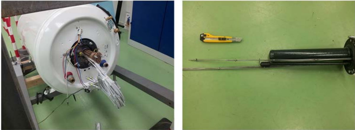
Figure III-4. Instrumentation du ballon avec une canne de sondes de température PT100 1/10 DIN disposées à l'intérieur du ballon par sa bride inférieure
