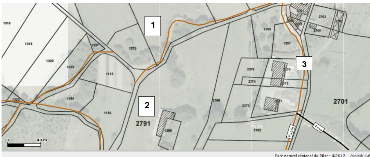
Figure 52 - Illustration des décalages existants entre la Bd Topographique et le cadastre
