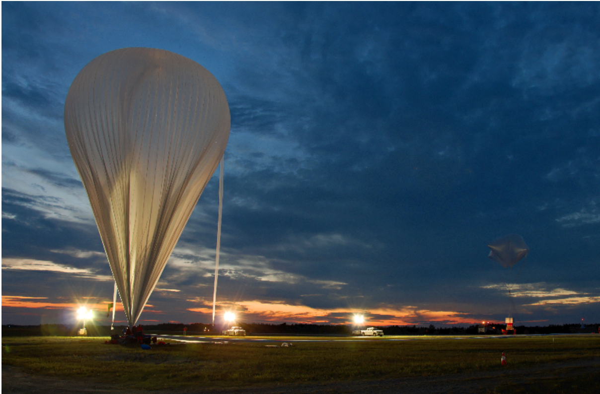
FIGURE 5.7 – Peut avant le décollage, alors que le ballon principal est en train d’être rempli d’hélium. On peut voir en arrière plan la nacelle avec un des deux ballons secondaires.
