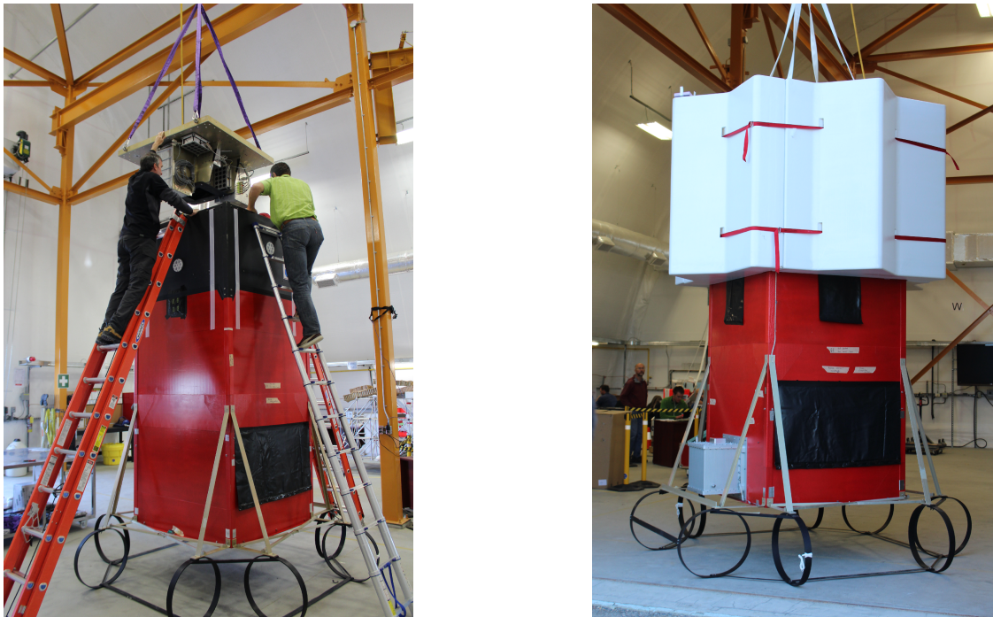
FIGURE 5.6 – Gauche : intégration de la plaque supportant l'électronique d'EUSO-Balloon dans la gondole. Droite : Gondole entièrement assemblée. On peut voir les flotteurs en haut en blanc, et les amortisseurs en bas. L'appareil en bas à gauche est la caméra IR.
