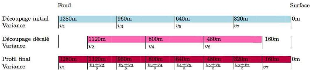
FIGURE 3.1 – Schéma du procédé de calcul de la variance par segments, à partir de la moyenne d’un découpage initial et d’un découpage en recouvrement. On a choisi un profil ayant une profondeur  $D = 1280m$ , des segments de taille  $s = 320m$  découpant la colonne d’eau du fond jusqu’à la surface, et un résidu  $d = 0$  en considérant le cas où la profondeur est un multiple de la taille du segment.
