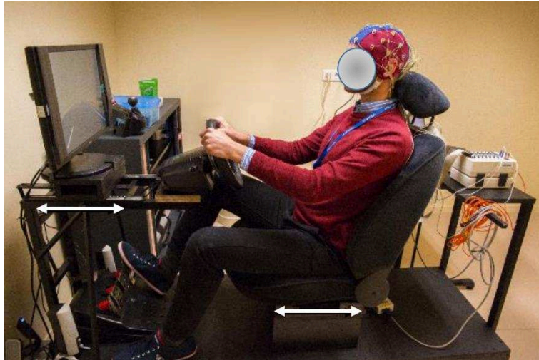
Figure 20 : Installation des participants lors de l'expérimentation sur le simulateur épuré. Les éléments importants de gauche à droite : écran, pédalier, volant, siège, dispositif EEG (les flèches blanches indiquent les éléments ajustables du poste de conduite). Photo tirée de Techer (2016), utilisant le même matériel
