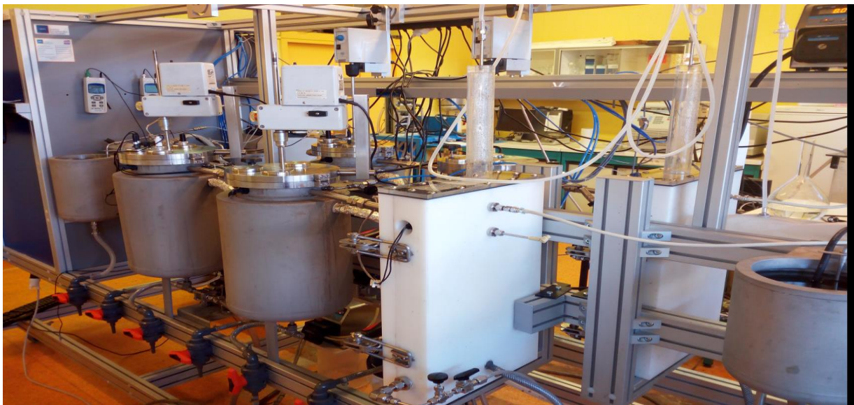
Figure 2.3 : Pilote Bàm 3 (Bàm anaérobie à membrane immergée)
