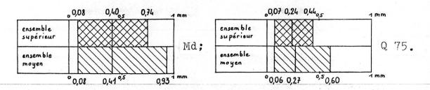
Dans le domaine granulométrique fin, les deux ensembles sont identiques (fig. 43). A partir de 0,80 mm environ pour Q 25, les deux ensembles se séparent nettement (fig. 43). Alors que les valeurs de Q 75 n'augmentent pas lorsque Q 25 augmente dans l'ensemble supérieur, les valeurs des deux paramètres augmentent simultanément dans l'ensemble moyen.
