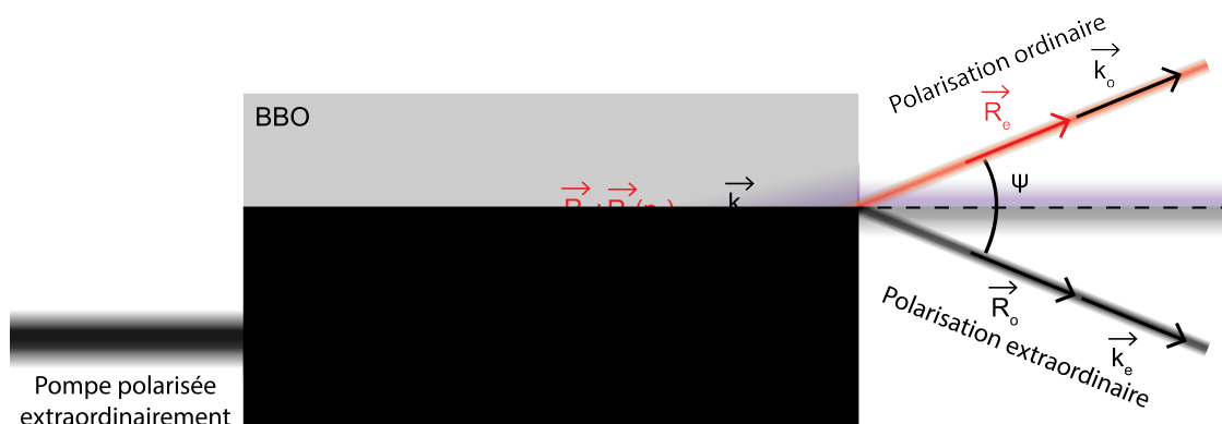
FIGURE 1.5 – Séparation spatiale des rayons signal et idler à la sortie du cristal non linéaire, pour un accord de phase non critique de type II, et une pompe polarisée extraordinairement.
