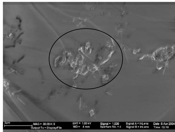
Figure I.19 : Fractographie des composites nanochargés montrant réagglomération des NTC (Gojny et al. 2005).
