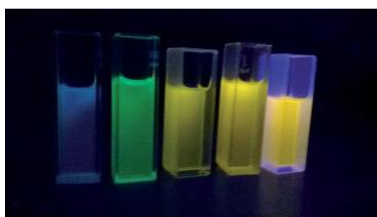
Figure 28 : Solvatochromie d'émission sous irradiation UV avec un dérivé de la pyrimidine (de gauche à droite : hexane, toluène, CHCl 3 , THF, CH 2 Cl 2 ; C = 10 -5 M)
