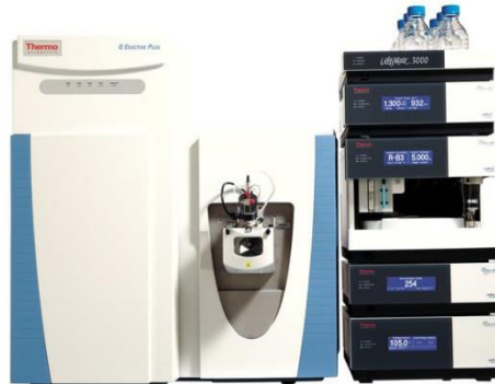
Figure 58. Système de chromatographie liquide couplée à la spectrométrie de masse haute résolution hybride quadripôle-Orbitrap™ Q Exactive™ Plus (ThermoFisher Scientific, Waltham, États-Unis).
