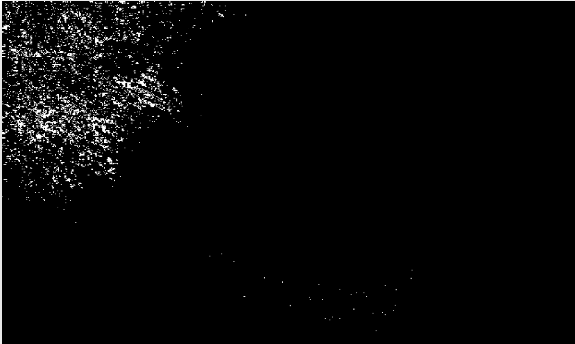
Figure 2.2 : résultat d'application de la méthode [20]. Différences de l'intensité lumineuse produisent des fausses détections à gauche, en haut de l'image. En supposant que chaque région blanche dans les images générées est un objet d'intérêt potentiel, le dénombrement direct par la méthode de composantes connexes calcule tous les objets. Les objets d'intérêt sont alors confondus avec du bruit dans des images binaires générées par la même méthode pour représenter les objets en mouvement d'un instant à l'autre.
