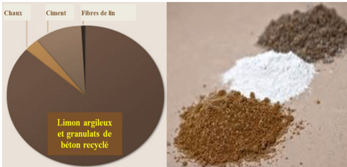
Figure 1. Composition de l'éco-béton de terre "Cematerre"
