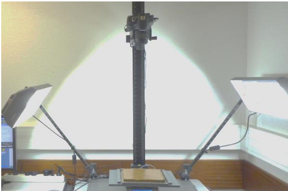
Figure 84. Banc d'essai pour analyse d'image. Statif-Appareil photo-Eclairage
