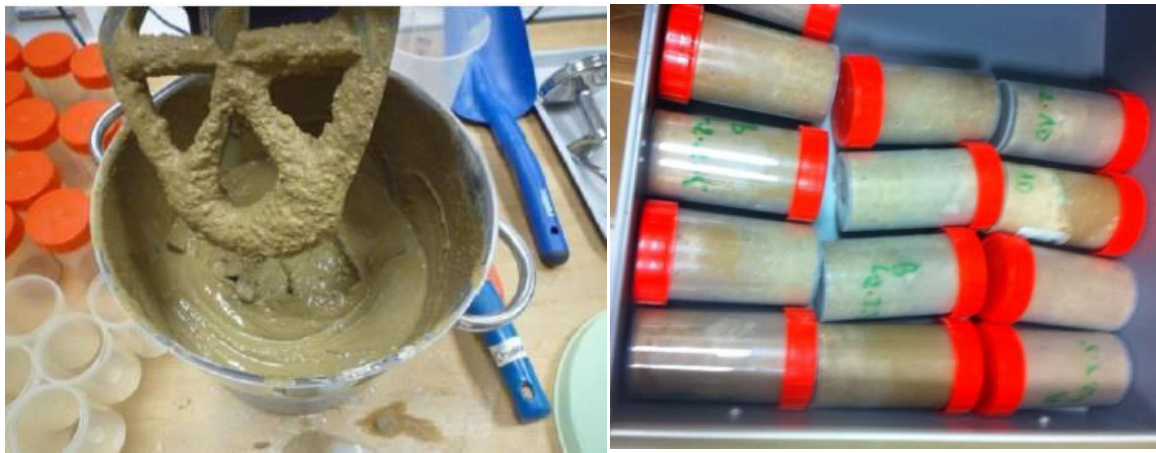
Figure 39. Préparation des éprouvettes pour analyse mécanique.
