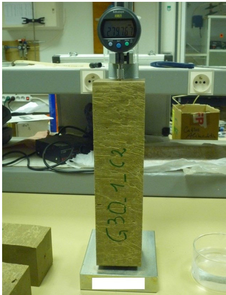
Figure 87. Dispositif de mesure du retrait linéaire.
