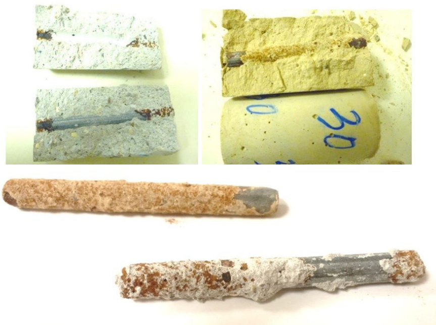
Figure 214. État des barres d'acier après 428 jours de maturation dans une chambre climatique
