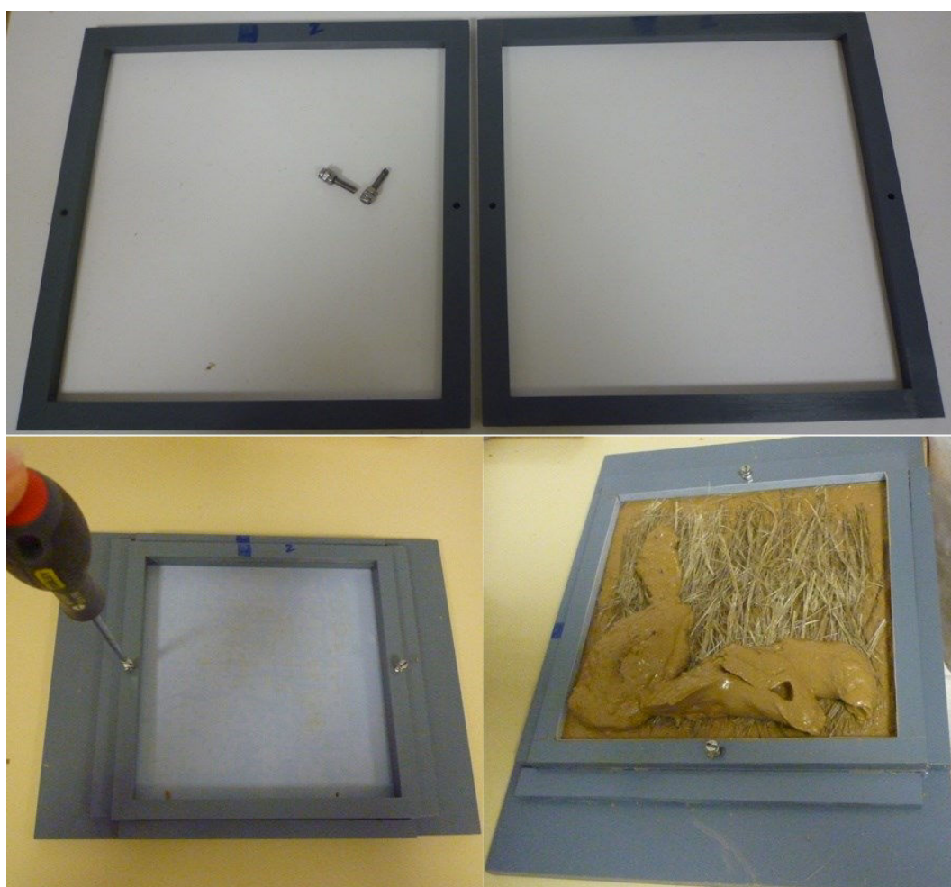
Figure 99. Préparation des essais pour la minimisation des fissurations avec des renforts.
