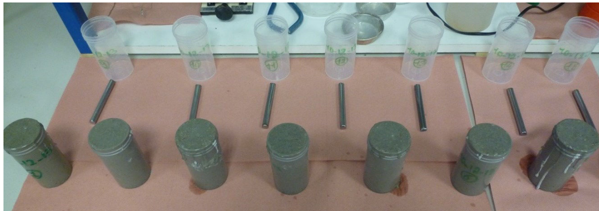
Figure 169. Fabrication des éprouvettes pour les essais macroscopiques.
