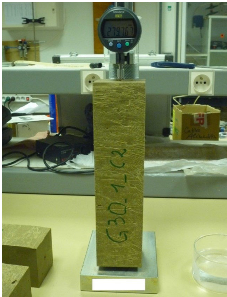
Figure 87. Dispositif de mesure du retrait linéaire.
