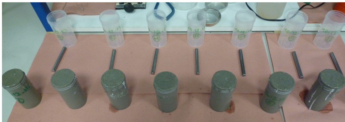
Figure 169. Fabrication des éprouvettes pour les essais macroscopiques.
