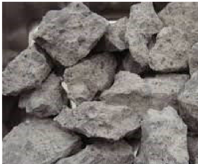
Figure 77. Granulats de béton recyclé RCA
