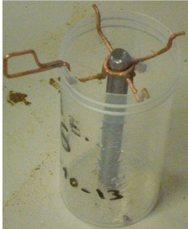
Figure 170. Essais macroscopiques. Guide de la barre au sein du moule
