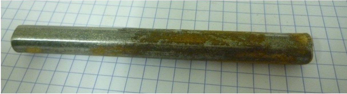
Figure 215. État de surface d'une barre d'acier nettoyée
