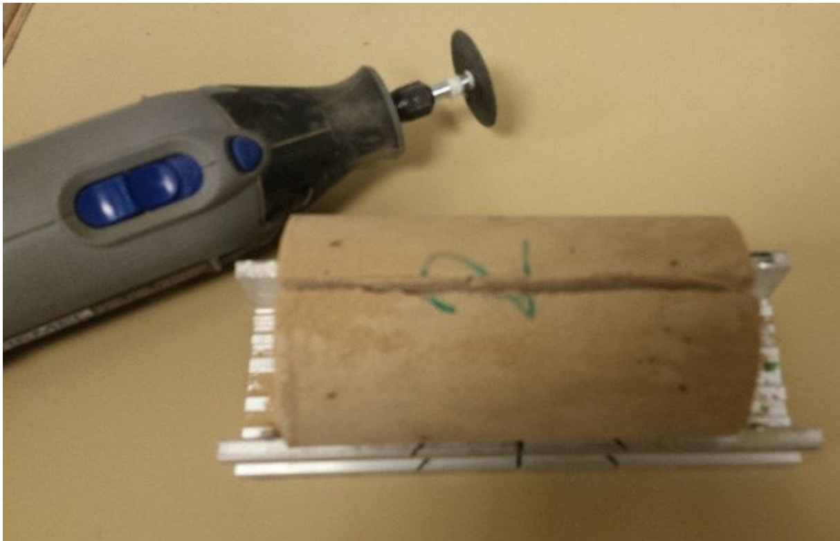
Figure 173. Essais macroscopiques. Destruction des éprouvettes.
